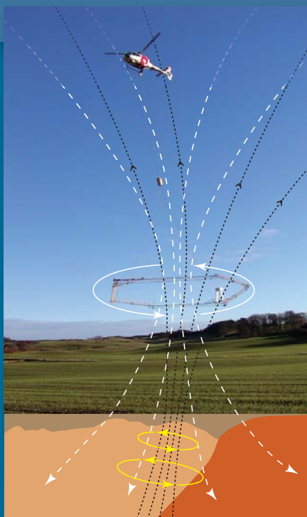
Helikopter med SkyTEM-systemet og skematisk gengivelse af de elektromagnetiske felter, som systemet henholdsvis skaber og måler. Illustration: Annabeth Andersen, GEUS omtegnet efter Aarhus Universitet, HydroGeophysics Group.
