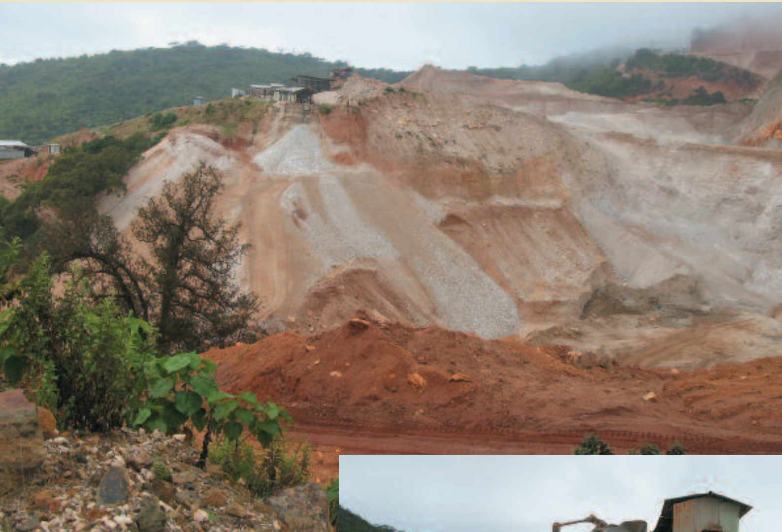
Et coltan-brud i Etiopien. Til højre ses, hvorledes malmen skubbes op til et anlæg, hvori der sker en første oparbejdning af malmen.
