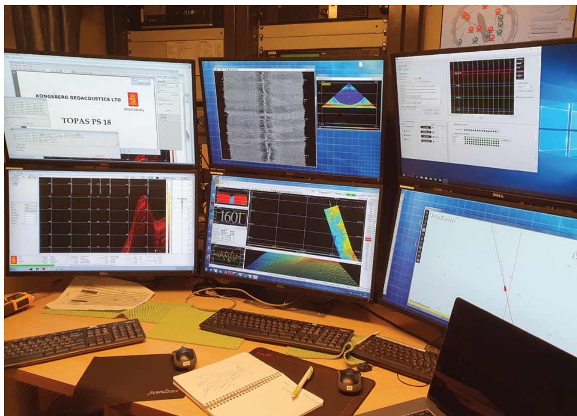
Et kig på arbejdsskærmene på sådan et forskningstogt. Der er gang i mange ting på en gang. Længst tv. kører sub-bottom profiler-programmet (SBP) med en tolkning af havbunden under skibet (røde kurver). I midten er to forskellige geologiske kort/målinger over havbunden i området, og til højre er skibets position og kurs på GPS.
