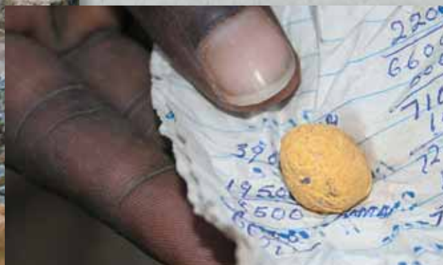
Guld udvundet ved hjælp af kviksølv, der er fordampet ved opvarmningen. Bemærk den lyse farve gullet har. Det skyldes, at gullet indeholder omkring 10 % kviksølv. Det sidste kviksølv bliver fjernet af guldhandlerne.
