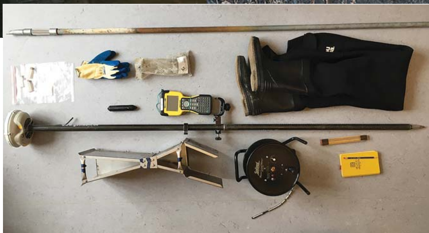
Mit vigtigste feltudstyr på en typisk arbejdsdag i felten. Piezometerrør med stålfilter i enden, prøveposer og vandprøveflaske, handsker, tommestok, waders, flume, tryktransducer (måler vandtryk) og temperaturlogger (lille sort cylinder), differential GPS, notesblok og pejll.
