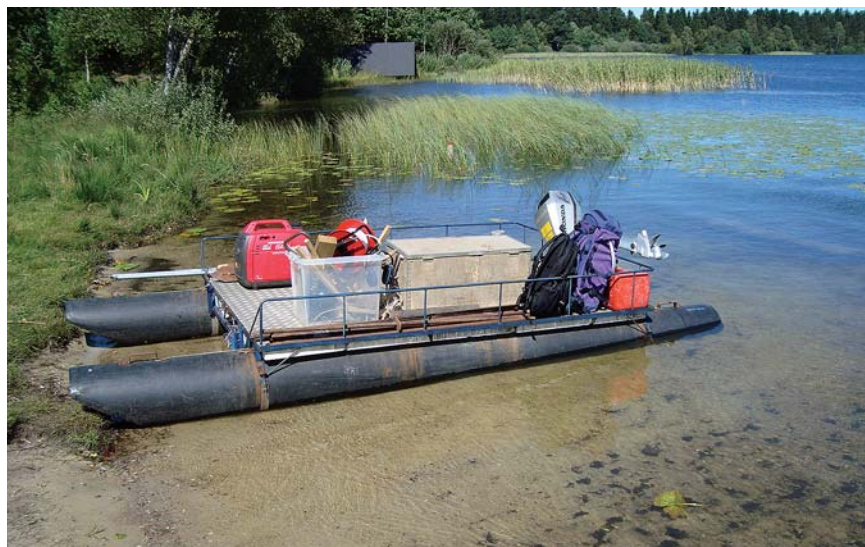
En tømmerflåde pakket til en dag i felten, hvor vi især arbejder med optagning af kerner og piezometer-installation.
