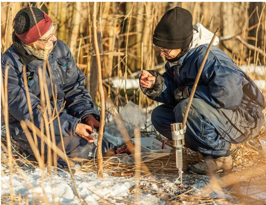
Her ses hvordan optagning af vandprøver ved hjælp af minipiezometre kan se ud.
