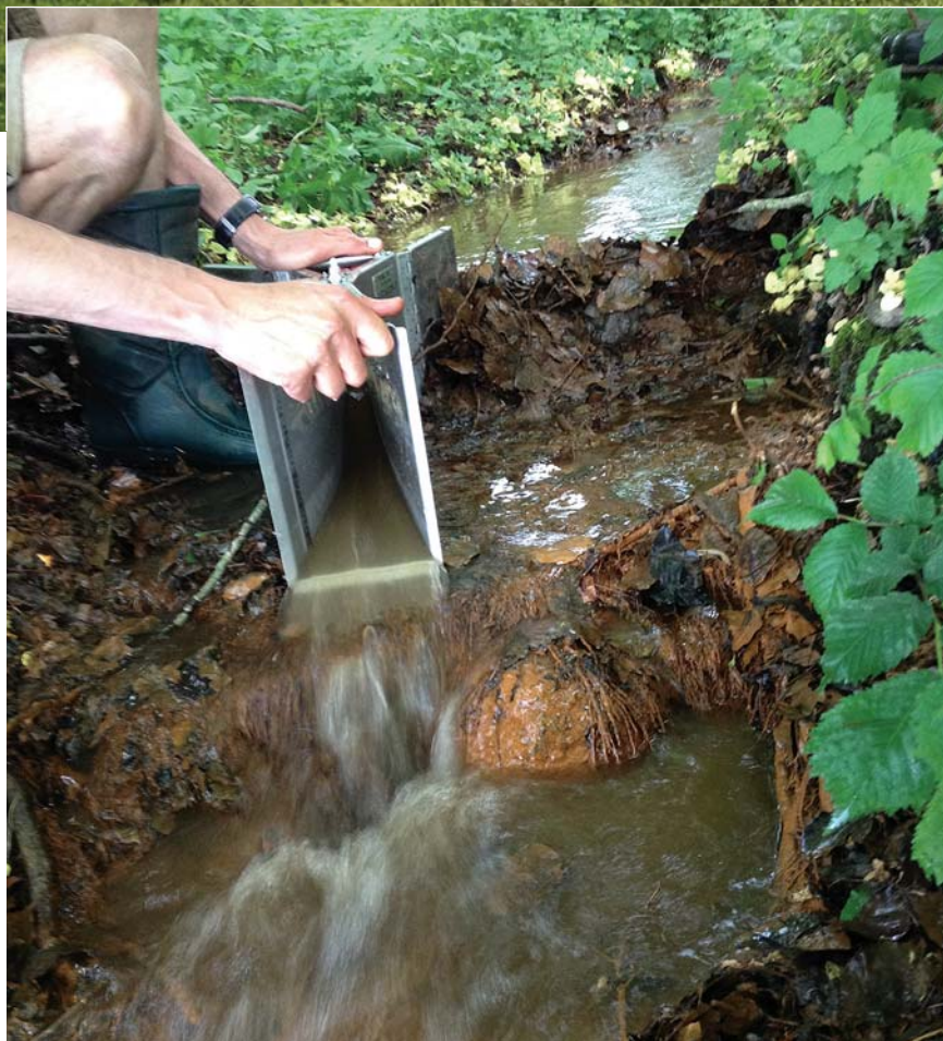
Flumen, også kaldet en transportabel strømningsrende, som måler vandtilstrømningen fra en grøft til Nørresø på Fyn.
